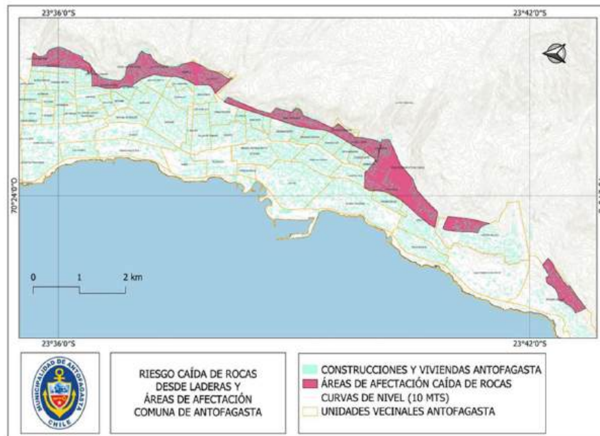
Figura 45 Riesgo de caída de rocas desde laderas en comuna de Antofagasta
